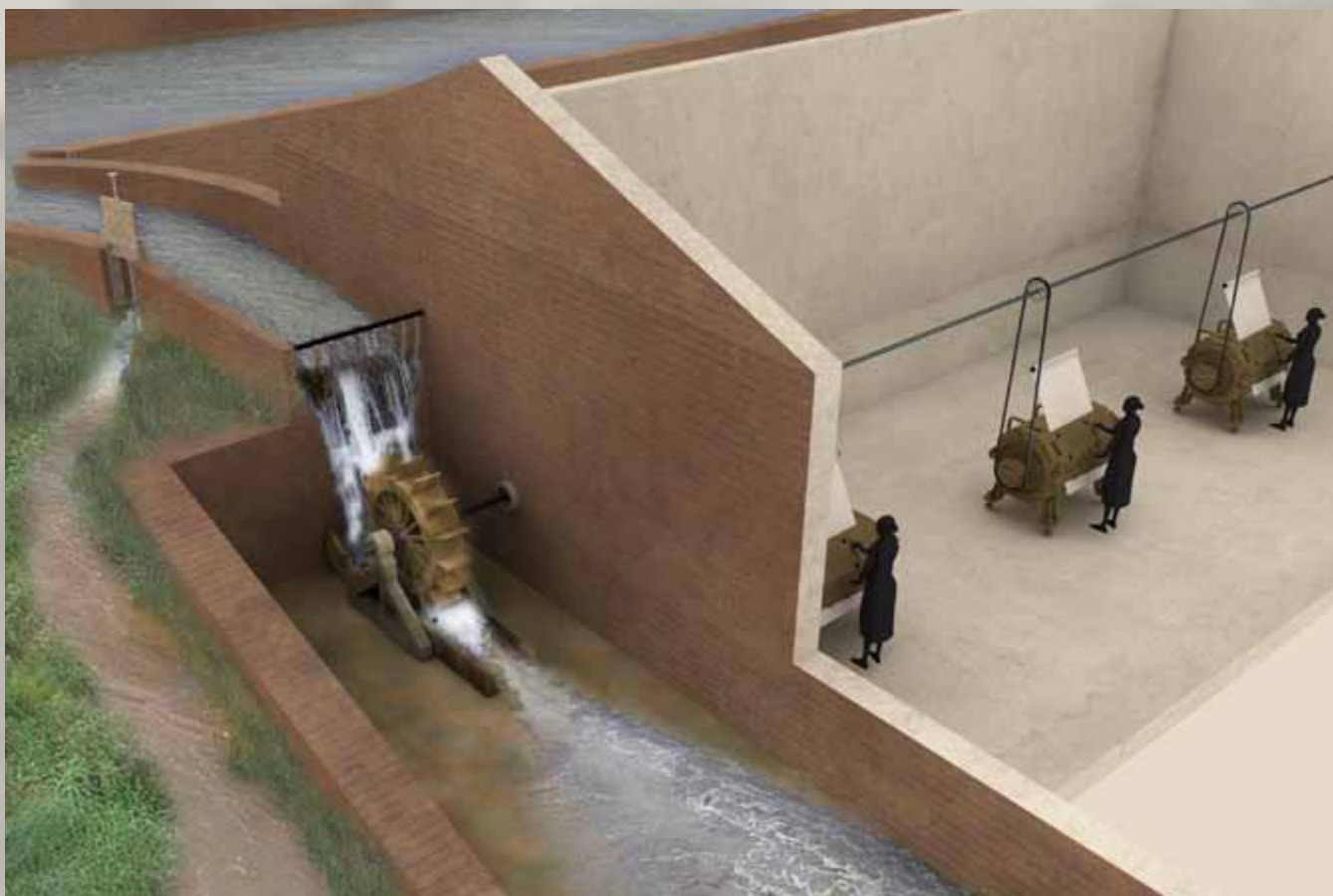
Esquema de funcionament d'un salt d'aigua, amb la roda hidràulica, l'eix central i el sistema de transmissió de l'energia mecànica. Autor: Centum
